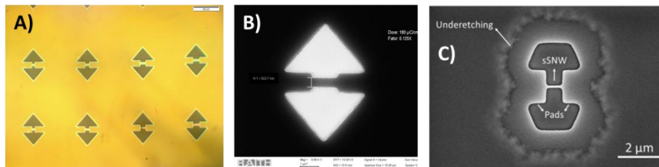
Figura 1: Otimização do processos de litografia e corrosão para fabricação das nanopontes de silício tensionado. A) Imagem de microscopia óptica mostrando um grupo de dispositivos logo após a litografia. B) Microscopia eletrônica de varredura (MEV) de um nanofios de 500 nm de largura antes do processo de corrosão e C) MEV de uma nanoponte de 120 nm de largura após a corrosão por ácido fluorídrico (apresentando underetch , o que é essencial para o processo de stress ).
